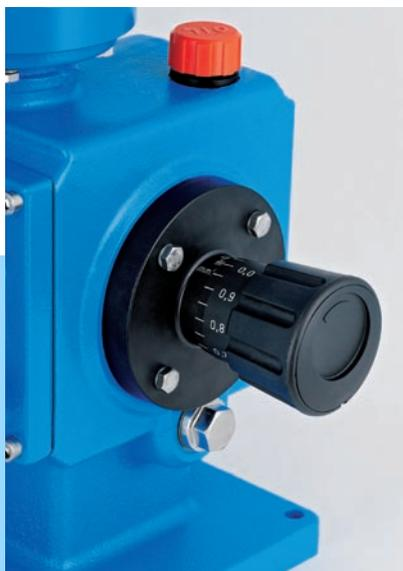
Линейная ручная регулировка величины хода поршня с шагом 0,05 мм при работающем или отключенном насосе.
