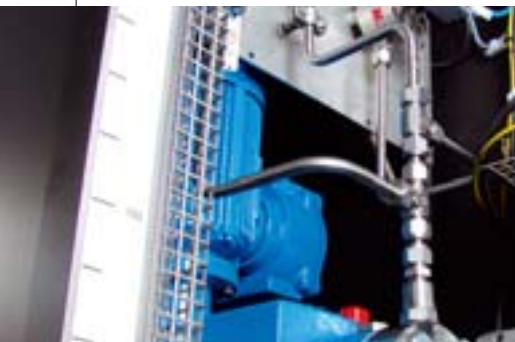
Бюрета для визуального контроля уровня одоранта в емкости и калибровки насоса
