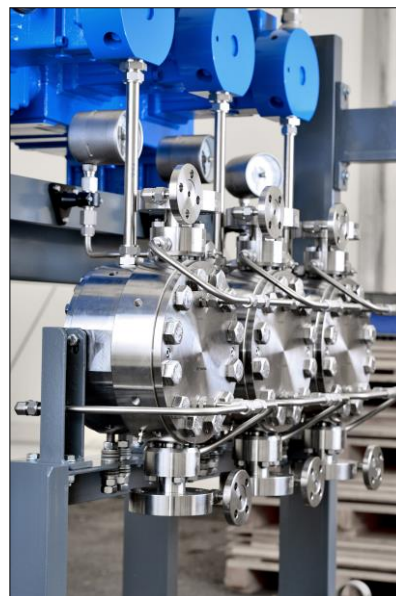
Пример исполнения: Ларомин (кристаллизуется при комнатной температуре), 220°C, 325 бар, 1560 л/ч
